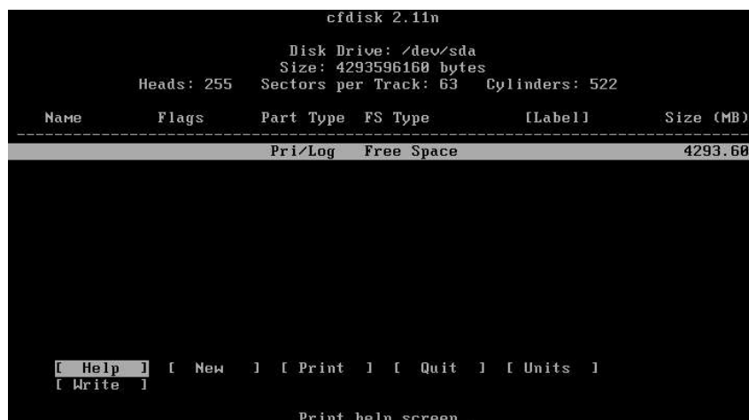
Obrazovka programu cfdisk . Dotyčný harddisk je zcela prázdný a má celkovou velikost 4.2GB
